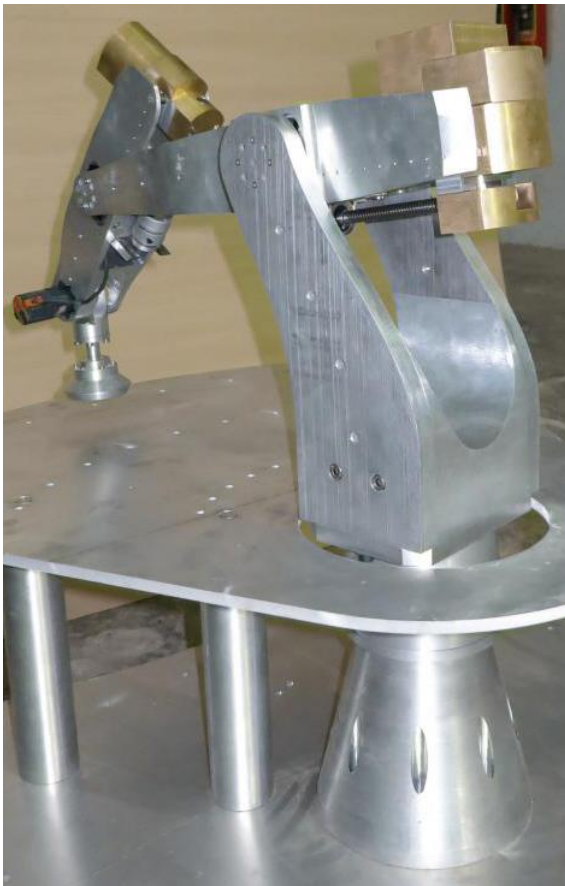
مدل CAD و ساخته شده ربات سه درجه آزادی خود بالانس
